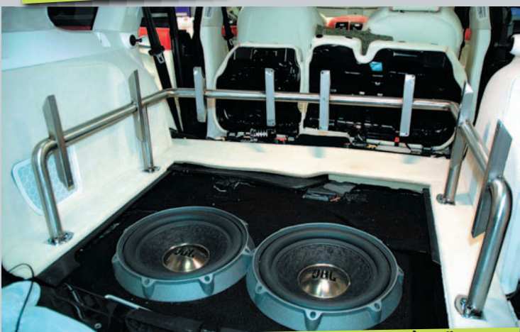
Voilà une bonne partie du matériel de monté... sans prendre aucun cm 2 du coffre. Pour placer le reste sans toucher au garnissage, l'astuce réside dans un châssis fabriqué en tube Inox.
