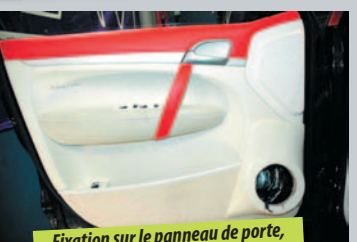
Fixation sur le panneau de porte, puis pose du panneau sur la porte.
