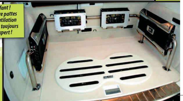
La fixation « aérienne » est parfaite pour les deux amplis, les deux filtres passifs et en plus le passage de tout le câblage à l'intérieur des tubes.
