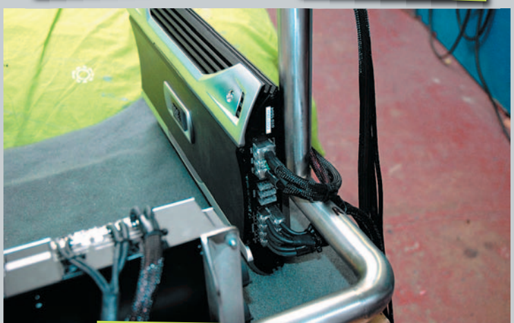
La fixation « aérienne » est parfaite pour les deux amplis, les deux filtres passifs et en plus le passage de tout le câblage à l'intérieur des tubes.
