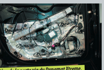
Dépose de la garniture puis insonorisation de la porte via du Dynamat Xtreme.
