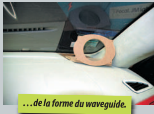
Découpe du support en medium à la fraiseuse à commande numérique...
