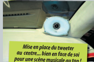
Fixation sur la grille au tableau de bord, moulage à la résine armée et ponçage.
