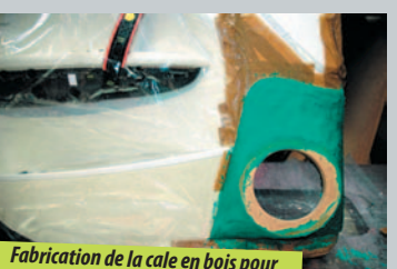
Fabrication de la cale en bois pour le medium avec de la résine armée.
